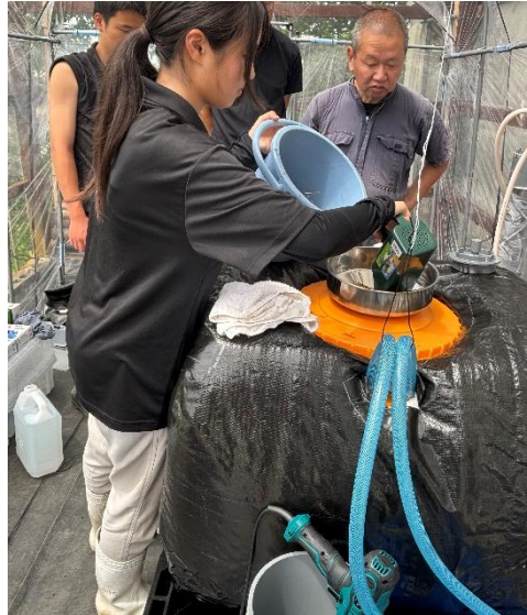
岐阜県立大垣養老高等学校に設置された手作りメタン発酵装置
